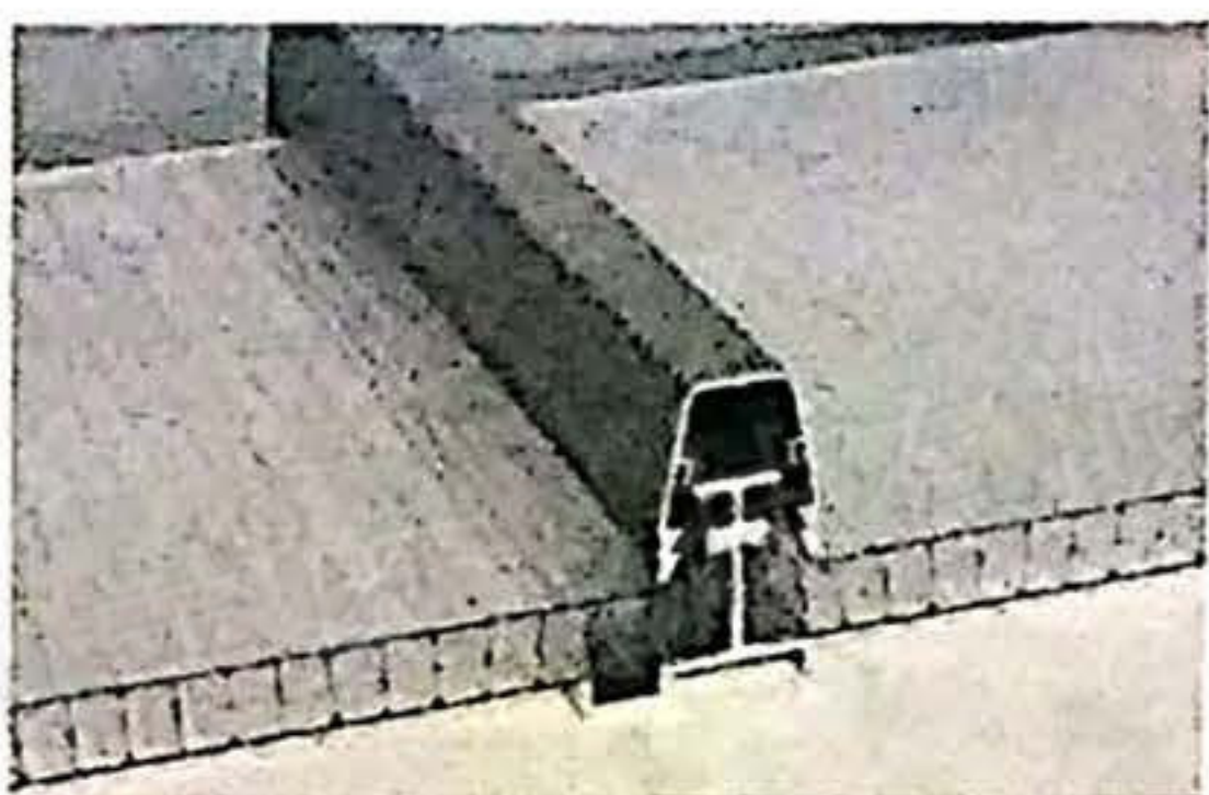
采光板连接示意3
