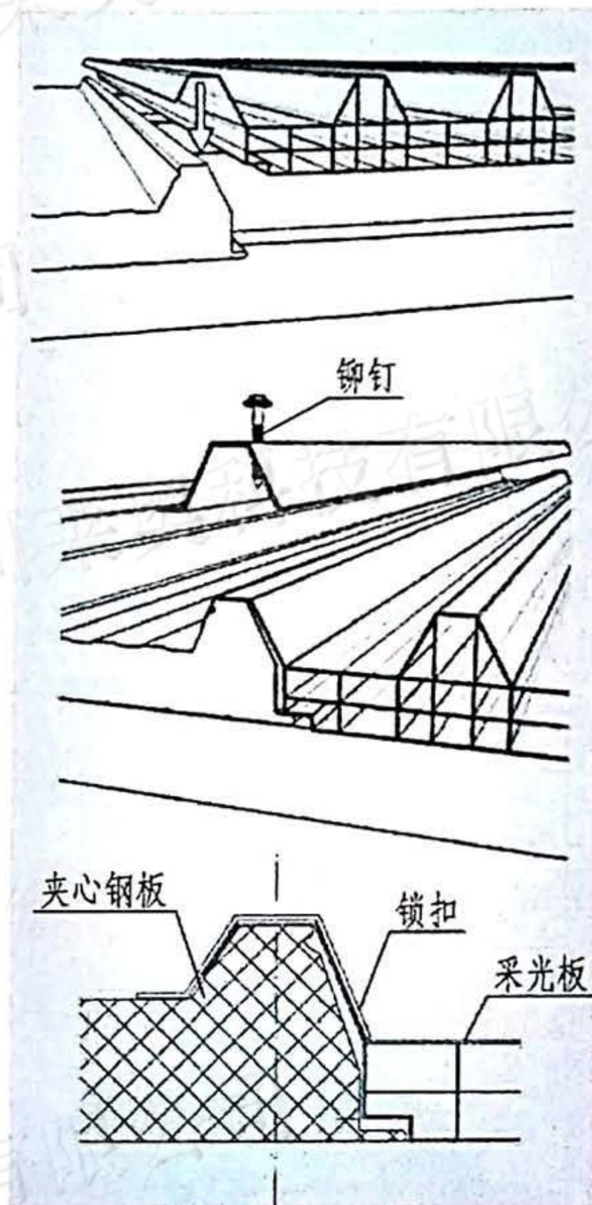
彩钢板与夹心钢板连接示意
